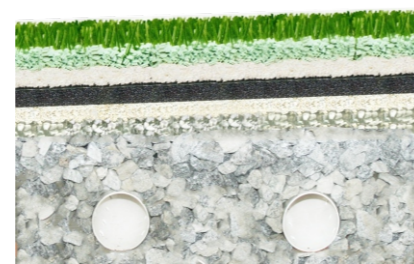
PVC Pipe \phi 60 \sim 100 \text{mm}
